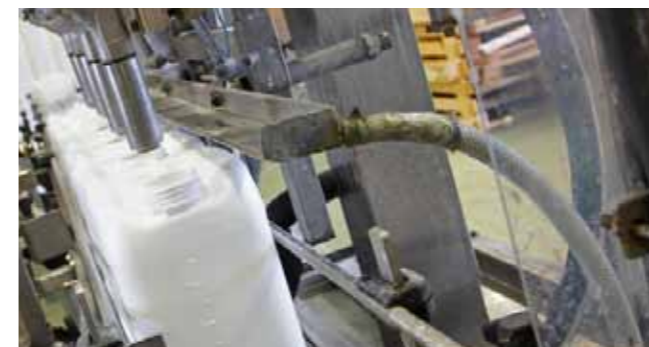
■ Zbiorniki są napełniane za pomocą objętościowych mierników przepływu, które bardzo precyzyjnie dozują płynne nawozy.
