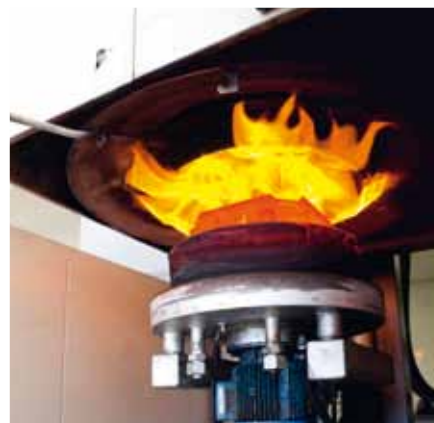
■ Elementy sektorów wsuwane są do nagrzanego pieca przez otwór w jego podłodze.
